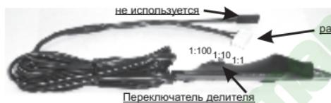
Функция «Осциллограф» поддерживается при подключении к прибору опционального кабеля «Multitronics ШП-2» с зажимом и переключаемым делителем напряжения.
